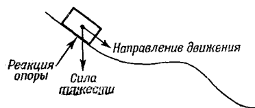
Ф и г. 14.1. Силы, действующие на тело, скользящее без трения.
