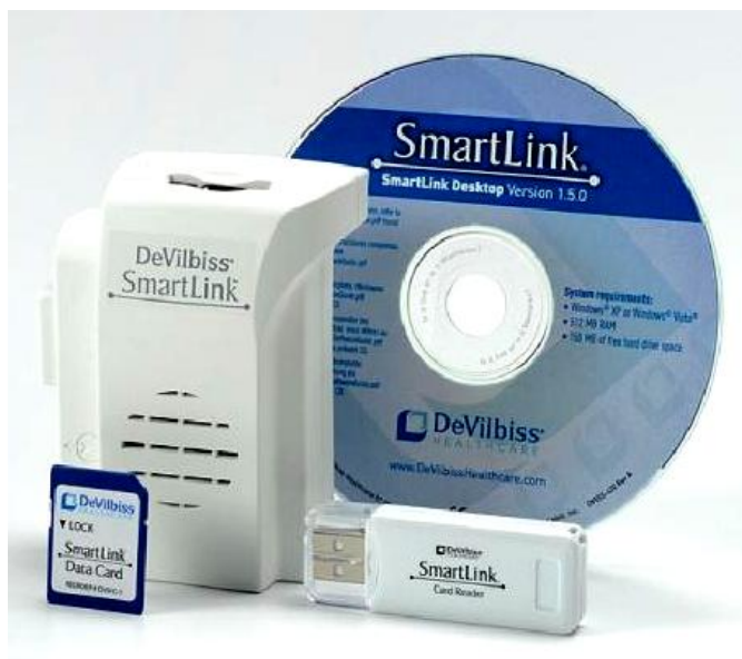
Рис. 49. Комплект SmartLink компании DeVilbiss, включающий специальный регистрирующий модуль, подключаемый к аппарату, программу, карточку памяти (data SD card), USB модуль для чтения карточки памяти (flash memory card reader).
