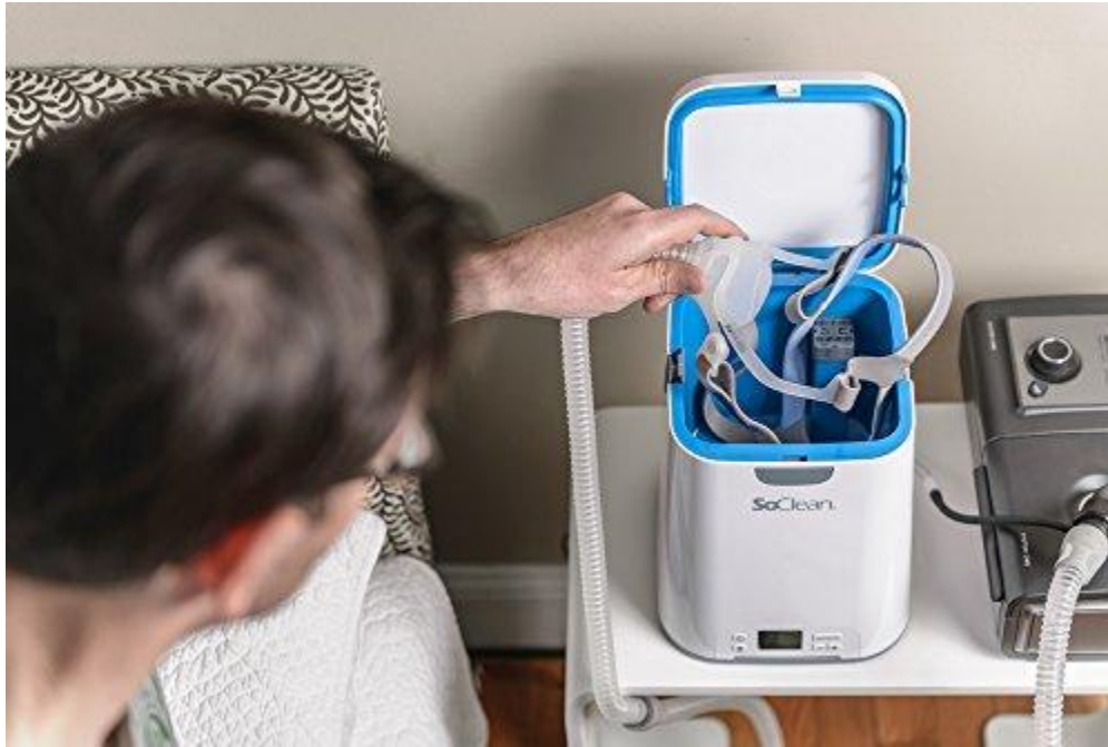
Рис. 36. Аппарат SoClean 2 для обеззараживания масок и шлангов CPAP
